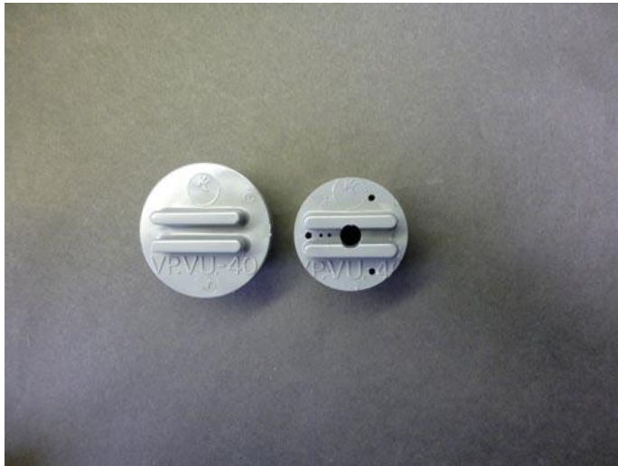
写真2. 4 掃除口(左…加工前/右…加工後)
