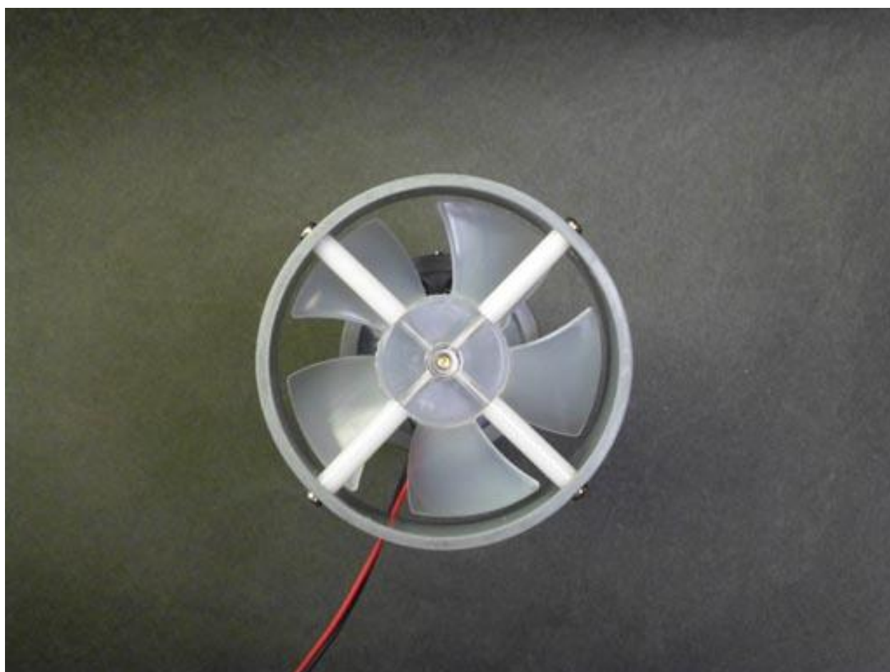
写真2. 8 プロペラとガードリングの位置決め
