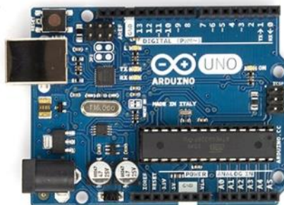
Fig.4.4.2 使用する制御基板
